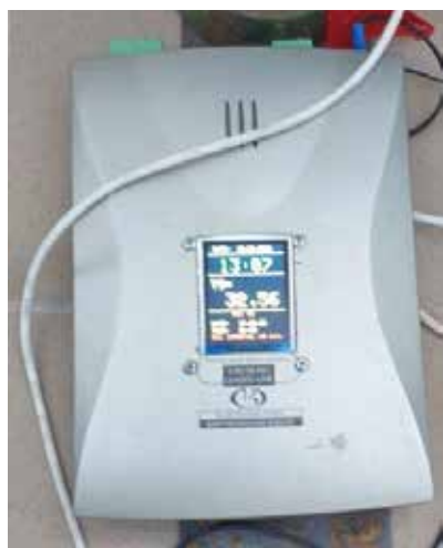
Рис. 3. Вторинні прилади для безперервного моніторингу значень температури на експериментальному стенді
